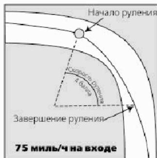
Допустим, в следующий раз гонщик расслабился и рулил **медленнее** (рисунок 2). Скорость байка, точка входа и угол наклона остаются постоянными. Как изменится траектория. Конечно, **распрямятся** (пунктирная линия).
